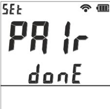
El emparejamiento exitoso se indica mediante un mensaje. Luego, el instrumento vuelve a mostrar las lecturas de medición.
